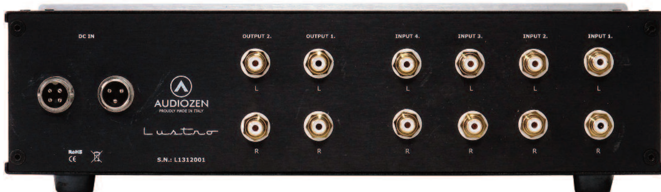
Il pannello posteriore del telaio del preamplificatore. da sinistra a destra i connettori per l'alimentatore esterno, le uscite di linea sdoppiate, e la teoria degli ingressi, tutti RCA.
