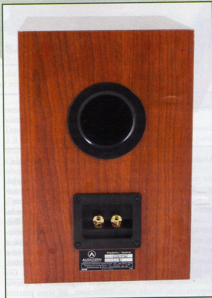
*Interamente in metallo l'unica coppia di connettori. Di precisione migliorabile, ma dalla compatibilità totale.*
